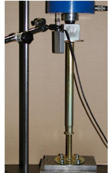
**Bild 4:** Prüfanordnung bei vertikal zentrischer Stützenbelastung
