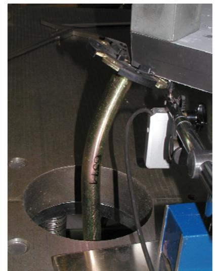
**Bild 3:** Prüfmuster #6571, Verhalten nach dem Erreichen der Versagenslast. Das Stützenrohr knickt aus.
