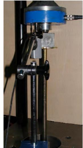
**Bild 5:** Prüfanordnung bei vertikal zentrischer Stützenbelastung
