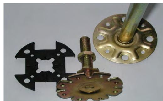
**Bild 1:** Einzelteile der geprüften Unterkonstruktion, Stützenfuß Variante 1, Stützenkopf und Auflageelement
