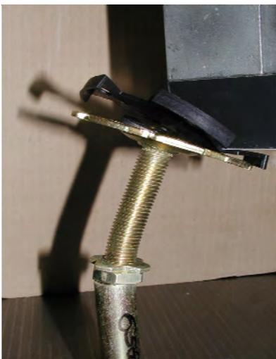
**Bild 4:** Prüfmuster #6588, Verhalten nach dem Erreichen der Versagenslast, Ausknicken des Gewindebolzens
