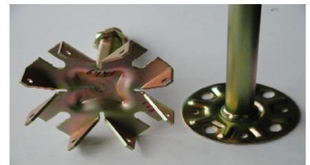
**Bild 2:** Einzelteile der geprüften Unterkonstruktion (Ausführung B, Stützenfuß-Variante 1 - Stützenrohr verschweißt)
