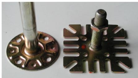
**Bild 1:** Einzelteile der geprüften Unterkonstruktion (Ausführung A, Stützenfuß-Variante 2 - Stützenrohr verpresst)
