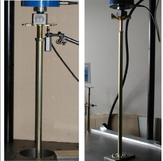
**Bild 4 und 5:** Prüfanordnungen bei vertikal zentrischer Stützenbelastung der Unterkonstruktion, Ausführung A (links) und Ausführung B (rechts)
